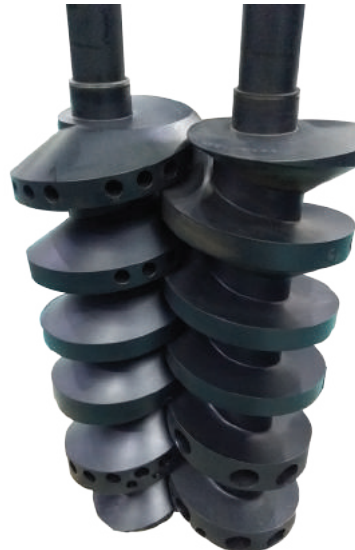
Tornillos impulsores en buen estado
