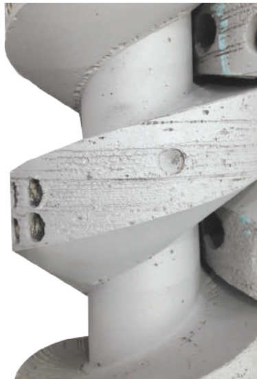
Tornillos impulsores dañados por cavitación
